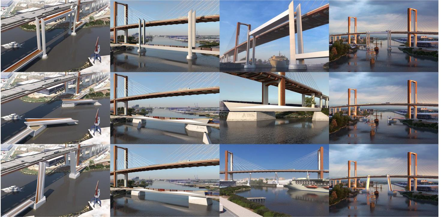
Redacción del anteproyecto de un puente móvil ferroviario para dar acceso, cruzando la dársena del puerto, a la terminal de contenedores del Puerto de Sevilla.
